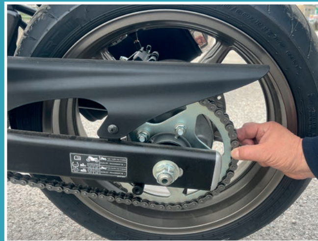
Überprüfung Dehnung (max. ein halber Zahn sichtbar, sonst tauschen)
