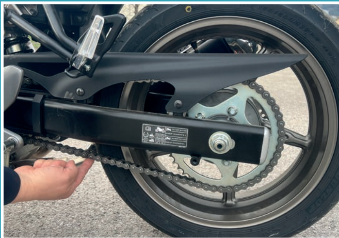
Überprüfung Spannung (lt. Bedienungsanleitung)
